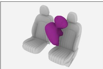
Der Fahrersitz verfügt zusätzlich zum Seitenairbag über einen Zentralairbag. Die Position des Zentralairbags ist in der Markierung **9.** auf Seite 1 dargestellt.
